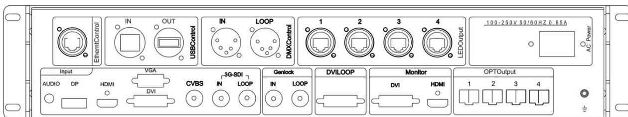
Ethernet:网口，可通过标准 TCP/IP 协议与 PC 连接通讯。
