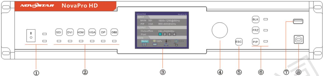
①：电源开关和指示灯，指示灯状态如下：
