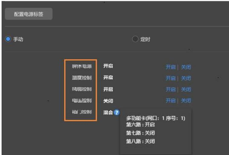
橙色框中的标签可以关联一路或多路继电器电路。当关联多路时，如果各路都开启（或关闭），则界面显示“开启”（或“关闭”）；否则，界面显示“混合”，并提供各路的信息。
