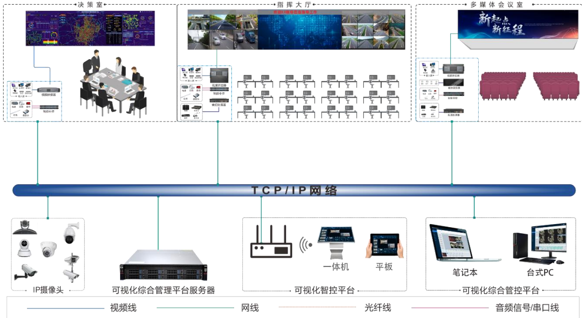
图 3-2 典型组网-分布式控制
