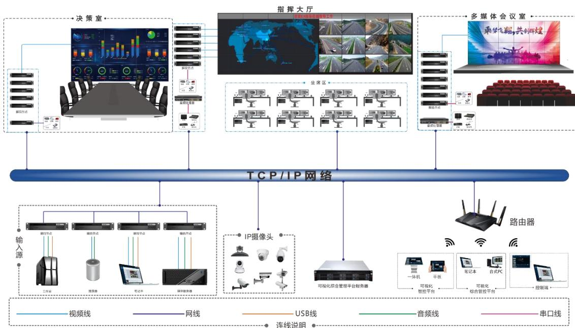
图 3-3 典型组网-分布式和拼接器集中控制
