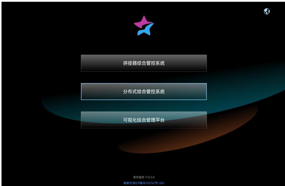
步骤 2 单击“分布式综合管控系统”，进入分布式综合管控系统配置界面。
