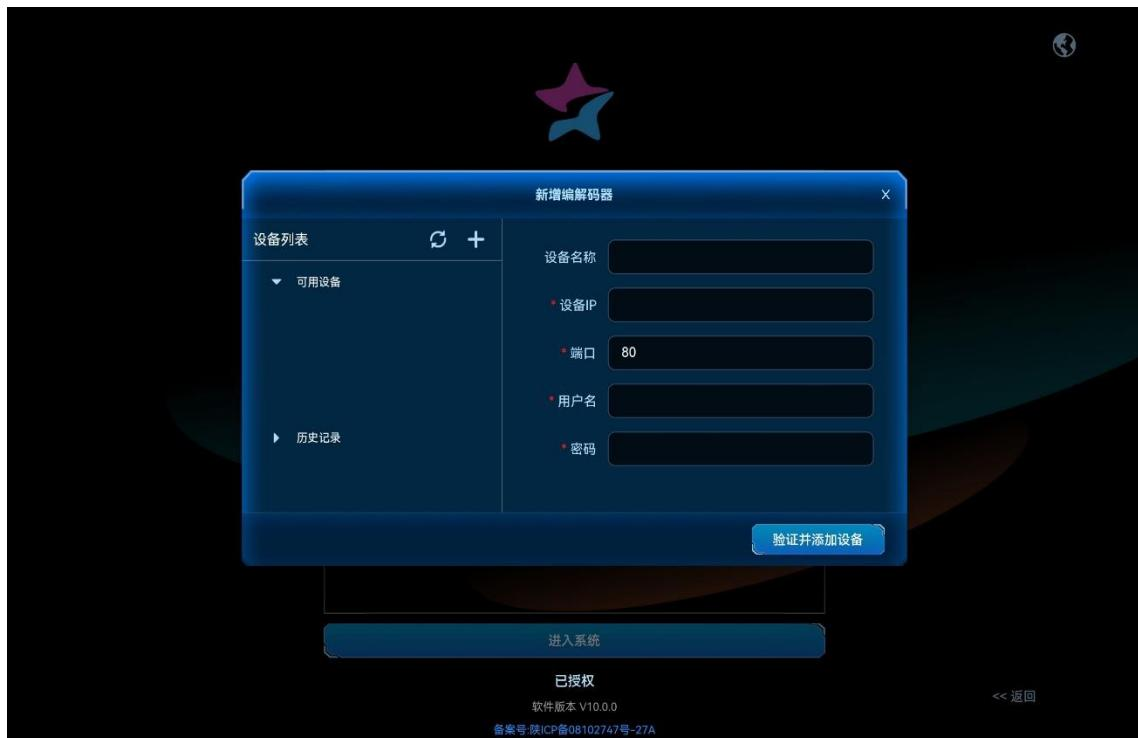
系统会自动搜索当前网络中的分布式设备，并将搜索到的设备 IP 地址显示在左侧的“可用设备”列表中。
