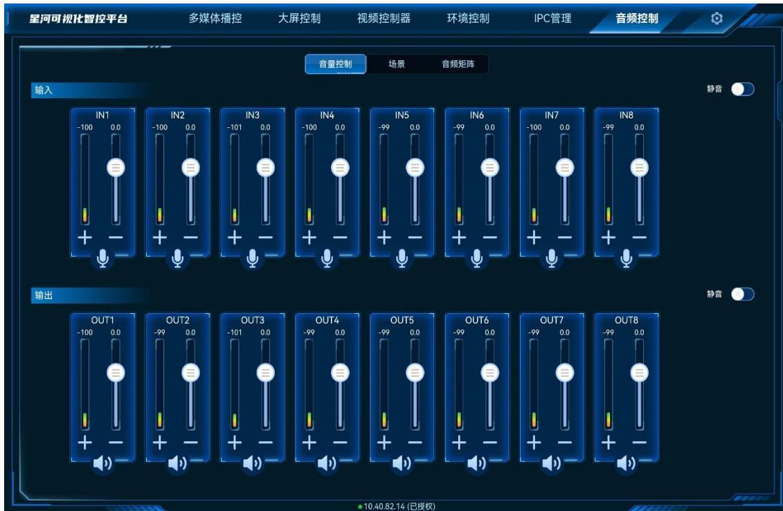
步骤 2 上下滑动输入输出区域的音量滑块可增加或减少音量。
