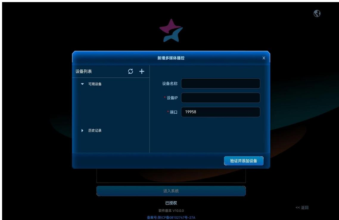
系统会自动搜索当前环境中可用的媒体服务器，并将搜索到的设备 IP 地址显示在左侧的“可用设备”列表中。
