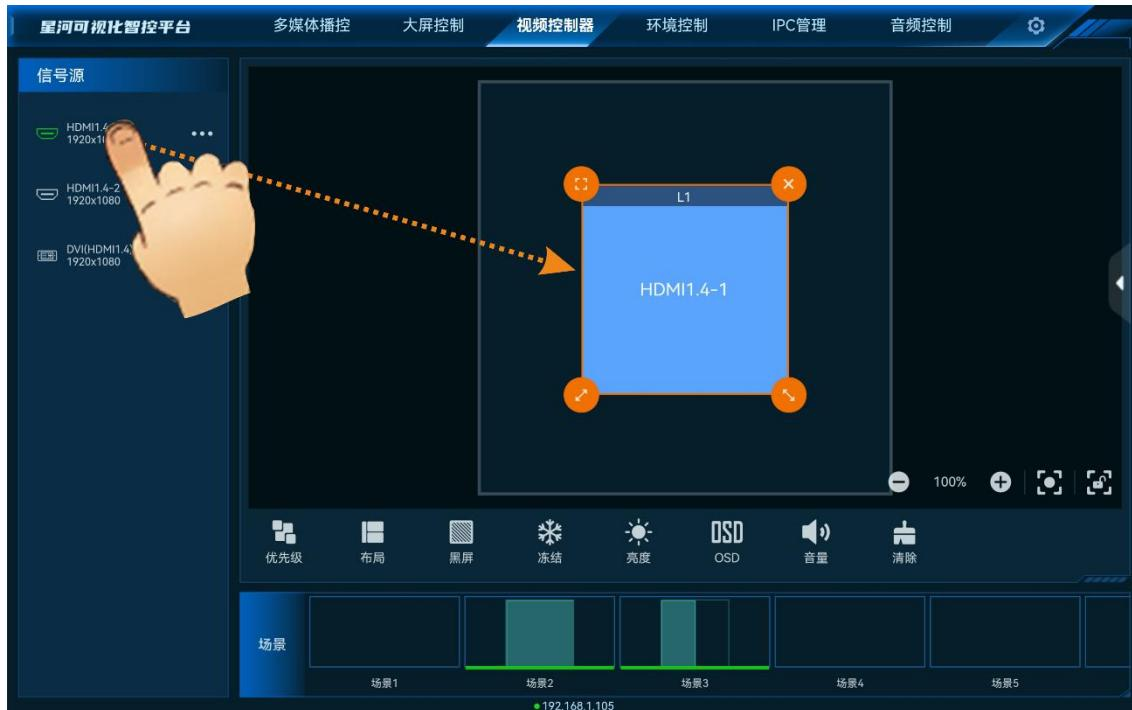
图层添加后或单击图层选中该图层，图层四周显示四个功能图标，可对图层进行快速调整。
