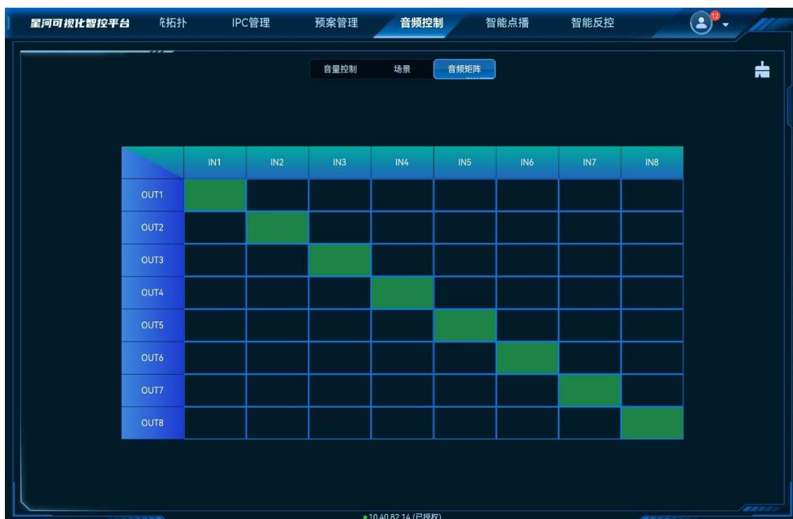
步骤 3 在矩阵界面，双击选择输入列与输出行对应的区域，系统自动完成输入输出接口关系配置。
