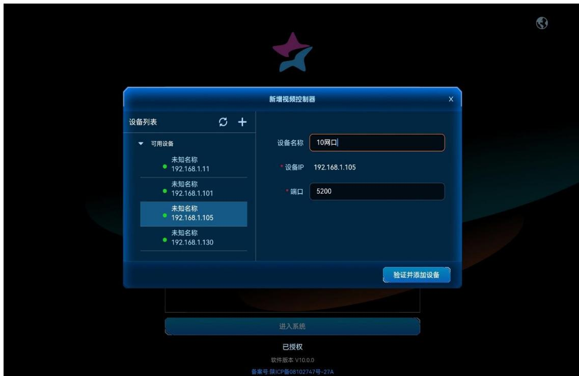
单击左侧“设备列表”右边的 **+**，即可清除右侧添加的信息，进入新增设备界面，可手动输入“设备名称”、“设备IP”和“端口”进行验证。
