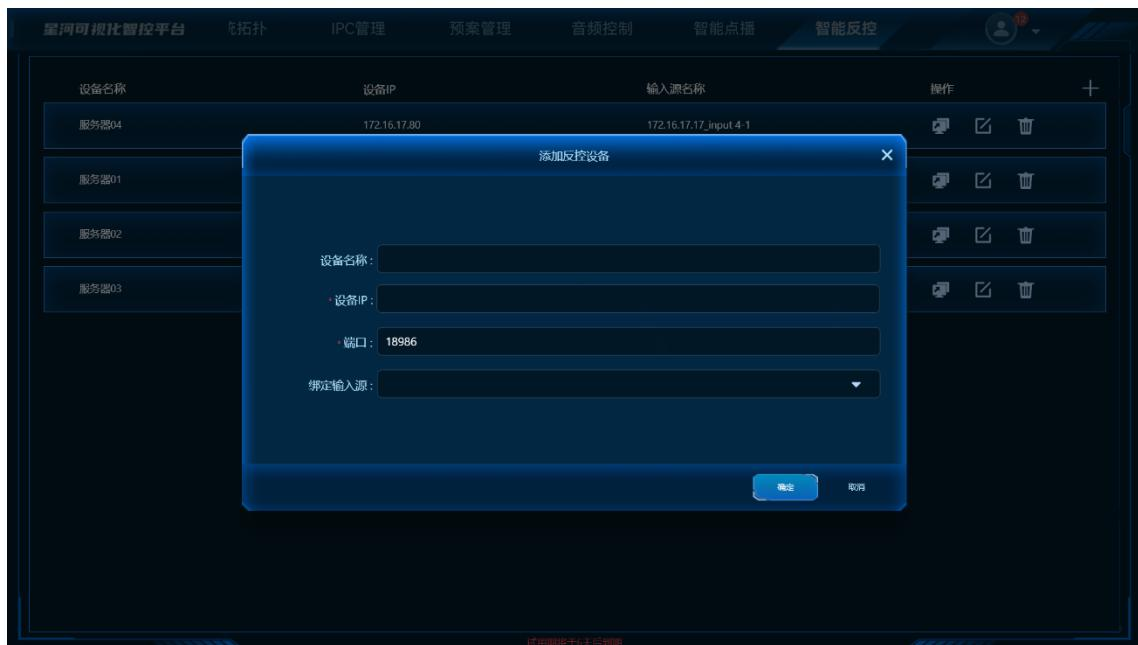
步骤 3 输入反控设备的“设备名称”、“设备 IP”、“端口号”等信息。
