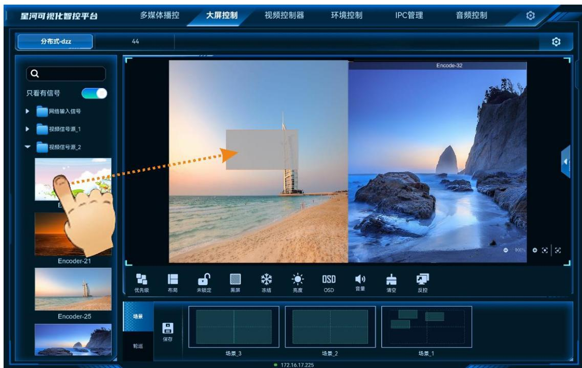
图 6-25 输入源切换完成
