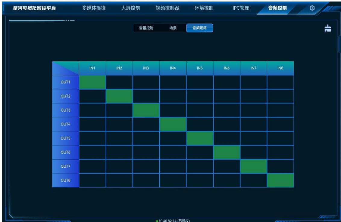
步骤 3 在矩阵界面，双击选择输入列与输出行对应的区域，系统自动完成输入输出接口关系配置。
