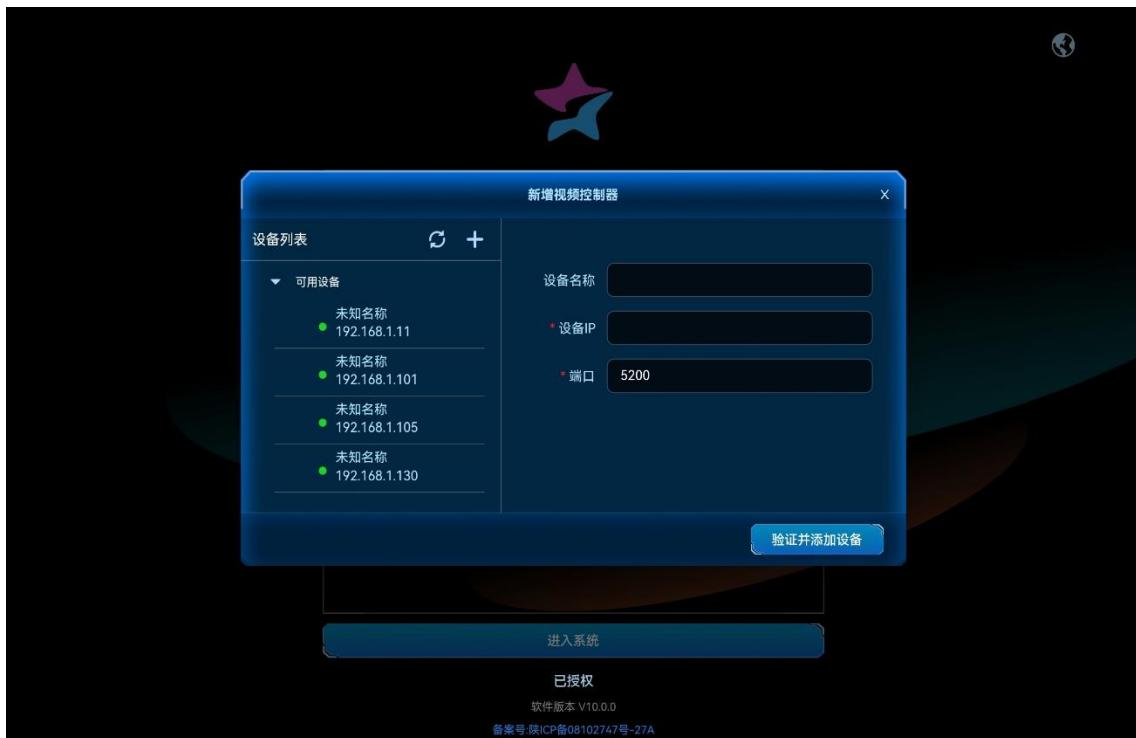
系统会自动搜索当前网络中的视频控制器，并将搜索到的设备 IP 地址显示在左侧的“可用设备”列表中。
