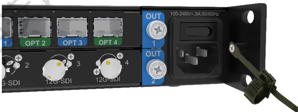
图3-5 固线环和固线带安装
